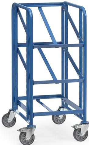
Stahlrohr und Profilstahl-Konstruktion, pulverbeschichtet RAL 5007. Schraubkonstruktion. Etagenrahmen variabel einschraubbar, Raster 50 mm, Neigung bei schrägem Einbau 15° oder 30°. Tragkraft obere und mittlere Ladefläche 80 kg. 3 Etagenrahmen passend für je 1 Eurokasten. 4 Lenkrollen, TPE-Bereifung, Naben mit Rillenkugellager. 2 Stück mit Feststeller, gemäß der Europäischen Norm EN 1757-3 (Sicherheit von Plattformwagen).
