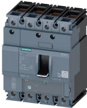
Leistungsschalter 3VA1 IEC Frame 160 Schaltvermögenklasse H Icu=70kA @ 415V 4-polig, Anlagenschutz TM220, ATFM, In=100A Überlastschutz Ir=70A...100A Kurzschlusschutz Ii=10 x In N-Leiterschutz 100% Klemmenanschluss
