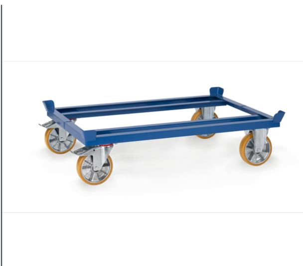
Construction en profilé d'acier mécano-soudé, revêtement époxy bleu RAL 5007, avec 4 inserts support de palettes. Pour palettes bois ou grillagées. 2 roues fixes et 2 roues pivotantes en polyuréthane jante en aluminium, moyeu à roulement à billes. Freins sur roues pivotantes conformément à la Norme EN 1757-3. Peu de résistance au démarrage et à la rotation. Déplacement silencieux sur sols plats. Roues non traçantes.
