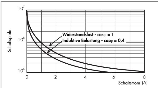
**H 48 - Gleichstromschaltvermögen bei DC1 - Belastung**
