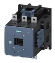
Leistungsschütz, AC-3e/AC-3 500 A, 250 kW / 400 V AC (50-60 Hz) / DC Uc: 42-48 V 3-polig, Hilfskontakte 2 S + 2 Ö Antrieb: konventionell Hauptstr.: Schiene Steuer- und Hilfsstromkreis: Federzuganschluss
