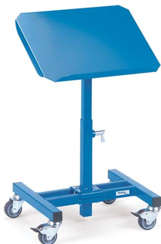
Pour bacs en plastique, bacs en tôle d'acier, corbeilles en fil métallique, etc., réglable en hauteur et mobile. Construction en profilé et tube d'acier avec plateau en tôle avec rebord sur un grand côté. Inclinaison de 0°, 15° et 30°. Hauteur réglable au pas de 25 mm. Revêtement époxy bleu RAL 5007. 4 roues pivotantes à bandage TPE, roulement à palier lisse. 2 roues avec freins conformément à la Norme 1757-3 (Sécurité des chariots de manutention).
