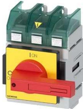
SETRON, Lasttrennschalter 3LD5 UL, Not-Aus-Schalter, 3-polig, approbiert nach UL489, UL60947-4-1 und IEC60947-3, UL: 125A, SCCR 65kA at 480VAC, Betriebsleistung @ 480VAC 3-phasig: 75hp, IEC: 125A, Betriebsleistung bei AC-23A bei 400V: 55kW, Bodenbefestigung mit Direktantrieb, rot/gelb inklusive Klemmenabdeckungen für die Einspeiseseite
