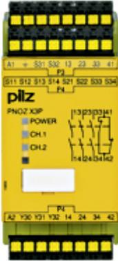
Sicherheitsschaltgerät (standalone), Eingänge: 1/2-kanalige Beschaltung mit/ohne Querschlusserkennung, Ausgänge: 3 S, 1 Ö, 1 HL, automatischer/überwachter Start, UB = 24 - 240 V AC/DC, Breite: 45 mm, steckbare Federkraftklemmen, Überwachung von Not-Halt, Schutztüren.
