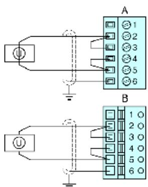
2-Draht-Thermoelement und Spannungssensor (mV)
