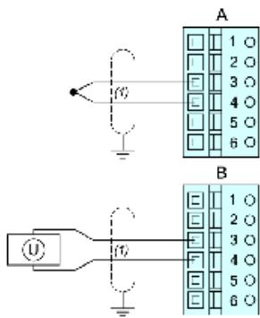
2-Draht-Thermoelement und Spannungssensor (mV) mit Vergleichsstellenkompensation
