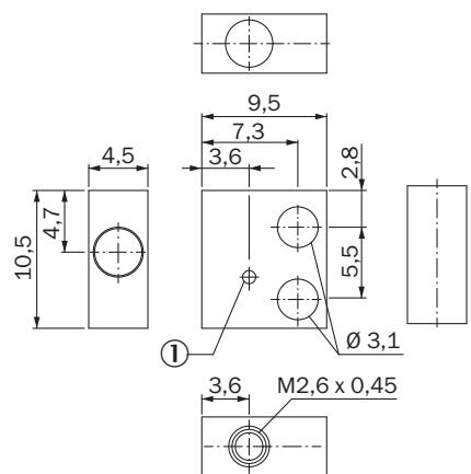
① Luftpumlassöffnung mit 1,0 mm Durchmesser
