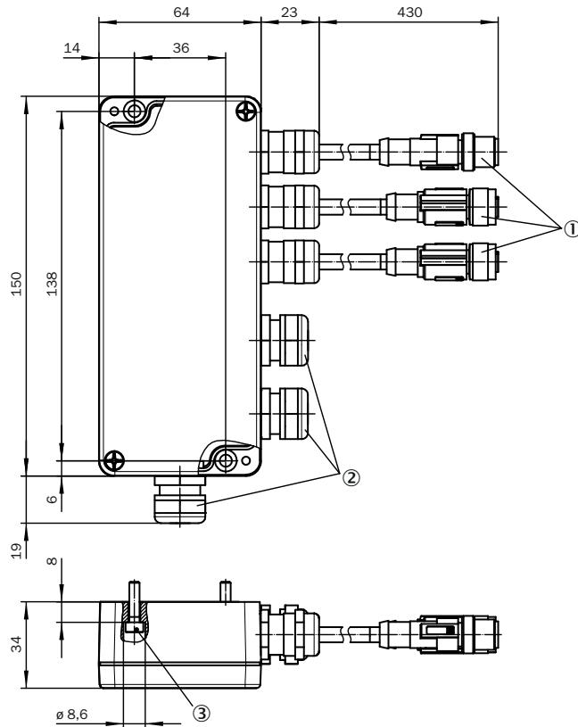
① Abbildung zeigt Anschlussbox mit Standardgehäuse, Steckerform von Artikelnummer 2095789 leicht abweichend
