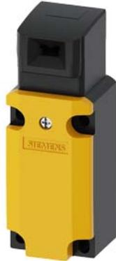
Sicherheits-Positionsschalter mit getrenntem Betätiger Kunststoffgehäuse 40 mm 1 x (M20 x 1,5) Schleichschaltglieder 1S+2Ö 5 Anfahrrichtungen der dazu passende getrennte Betätiger 3SE5000-0AV0. muss separat bestellt werden
