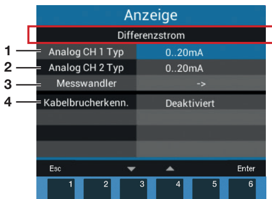
Abb. Fenster Anzeige „Differenzstrom“ mit den Einstellungen der Parameter für den Messmodus Differenzstrom .
