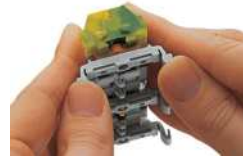
Klemmenleiste mit Rastfüßen Anrasten des Montagefußes (209-120) (Der Abstand der Montagefüße zueinander unter einer Klemmenleiste soll ca. 25 ... 30 mm betragen.)
