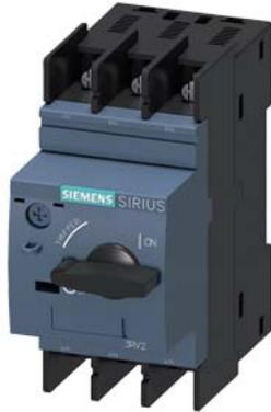
Leistungsschalter Baugröße S00 für den Motorschutz, CLASS 10 A-Auslöser 1,8...2,5 A N-Auslöser 33 A Ringkabelschuhanschluss Standardschaltvermögen
