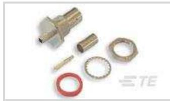
HF-Schnittstelle: **BNC**HF-SteckverbinderAusführung: **Klinke**HF-Steckverbinder Außendurchmesser gesteckt (ca.): **14.53 mm [ .572 in ]**Impedanz: **50 Ω**Mit HF-Kabeltyp kompatibel: **Raychem CLFH-316, Raychem EPD 26995Q, Raychem 5026A1318, Raychem 5026A1331, Raychem 5026A1631, Raychem 5026C1309, Raychem 5026D1028, Raychem 5026D1424, RG 174A, RG 188A, RG 316, URM 95**
