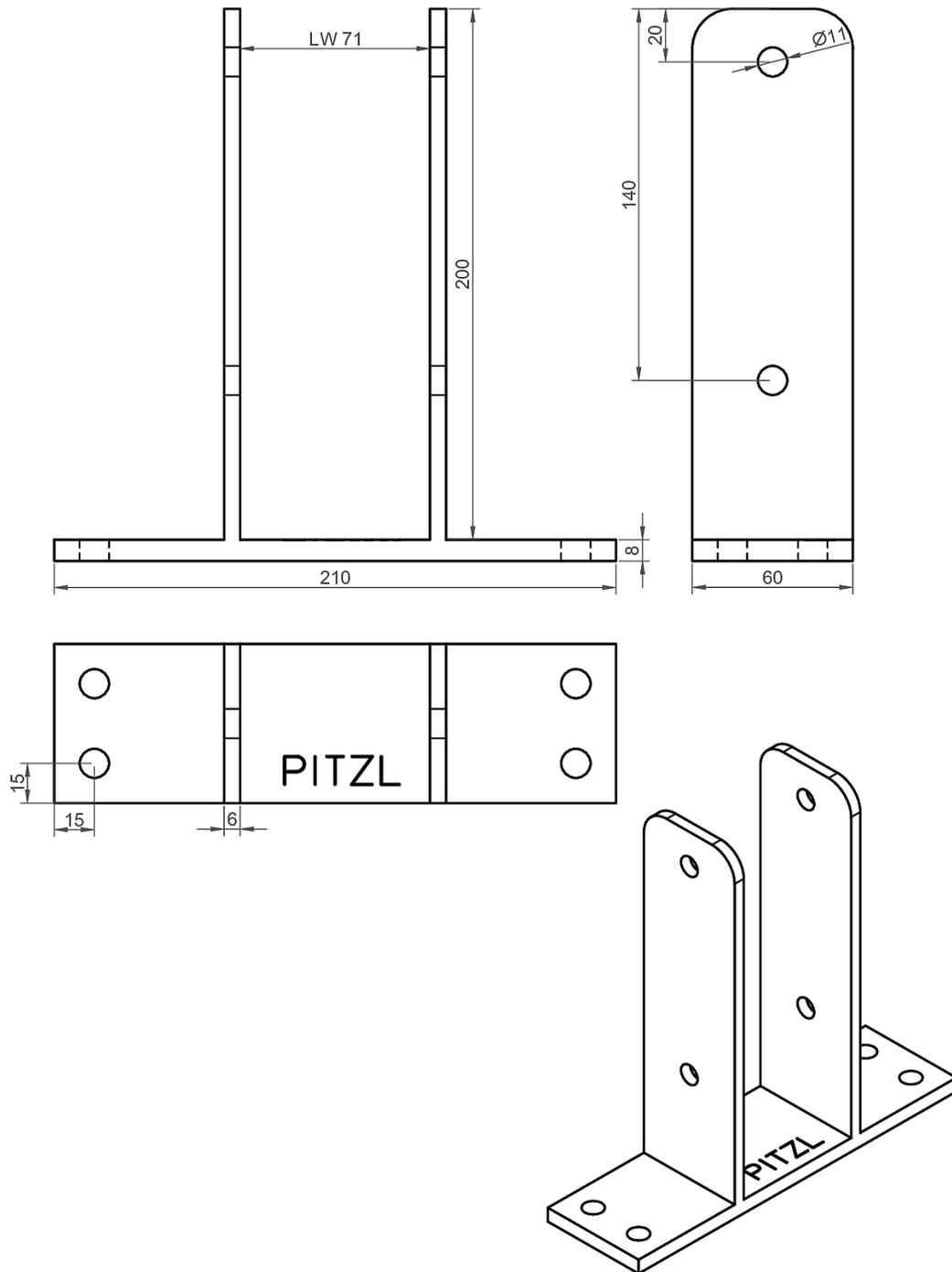
Pfostenträger Pfostenanker feuerverzinkt
