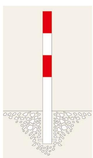
Einbetonierte Sperrpfosten sind insgesamt 1330 mm hoch, davon 330 mm Unterflur
