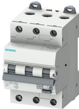
FI/LS-Schalter, 6 kA, 3P Typ A, 30 mA, B-Char, In: 6A Un: 400V
