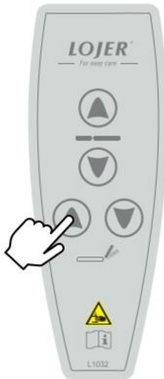
Figur 27. Einstellung des Rückenteils. Handsteuergerät.
