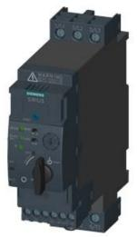
SIRIUS, KOMPAKTABZWEIG, DIREKTSTARTER FUER IO-LINK, 690 V, DC 24 V, 1 ... 4 A, IP20, ANSCHLUSS HAUPTSTROMKREIS: SCHRAUBANSCHLUSS, ANSCHLUSS STEUERSTROMKREIS: SCHRAUBANSCHLUSS
