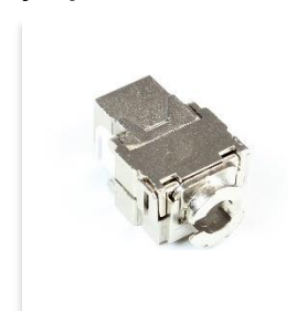
Embase RJ45 Catégorie 6a, 100% blindée Keystone, Compatible POE+, Transfert des données jusqu'à 10 000 Mbits/sec
