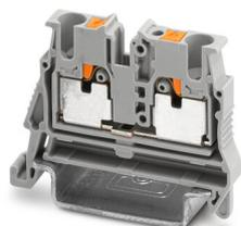
Minidurchgangsklemme, Nennspannung: 800 V, Nennstrom: 24 A, Anzahl der Anschlüsse: 2, Polzahl: 1, Anschlussart: Push-in-Anschluss, Bemessungsquerschnitt: 2,5 mm<sup>2</sup>, Querschnitt: 0,14 mm<sup>2</sup> - 4 mm<sup>2</sup>, Montageart: NS 35/7,5, NS 35/15, Farbe: grau
