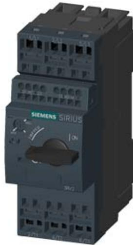
LEISTUNGSSCHALTER BGR. S0, FUER DEN MOTORSCHUTZ, CLASS 10, A-AUSL. 27...32A, N-AUSL. 400A, FEDERZUGANSCHLUSS, STANDARDSCHALTVERMOEGEN, MIT QUERL. HILFSSCHALTER 1S+1OE
