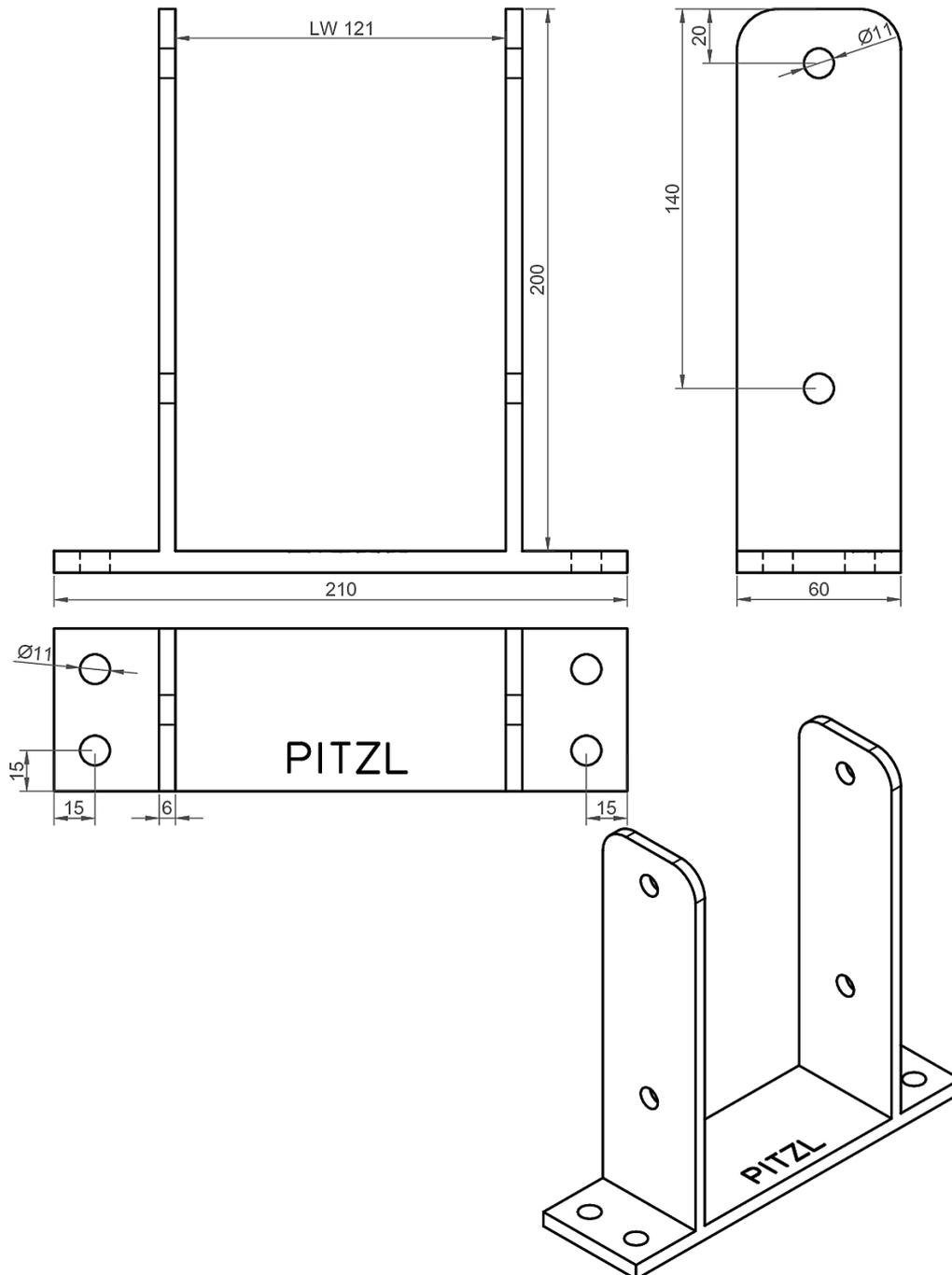
Pfostenträger Pfostenanker feuerverzinkt
