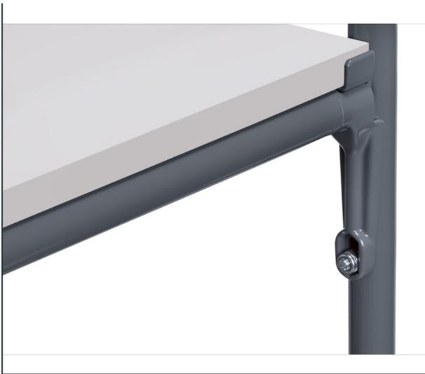
Diese elektrisch leitfähigen Streben in schiefergrau werden einfach unter einer vorhandenen Etage verschraubt. Das stabilisiert den Aufbau und erhöht die Tragkraft der Einlegeböden. Der Boden, der über den Versteifungsstreben liegt, trägt durch die Unterstützung 110 kg anstatt 50 kg. Die elektrische Leitfähigkeit wird dabei erhalten. 1 Paar wird pro ESD-Etagenwagen mitgeliefert.
