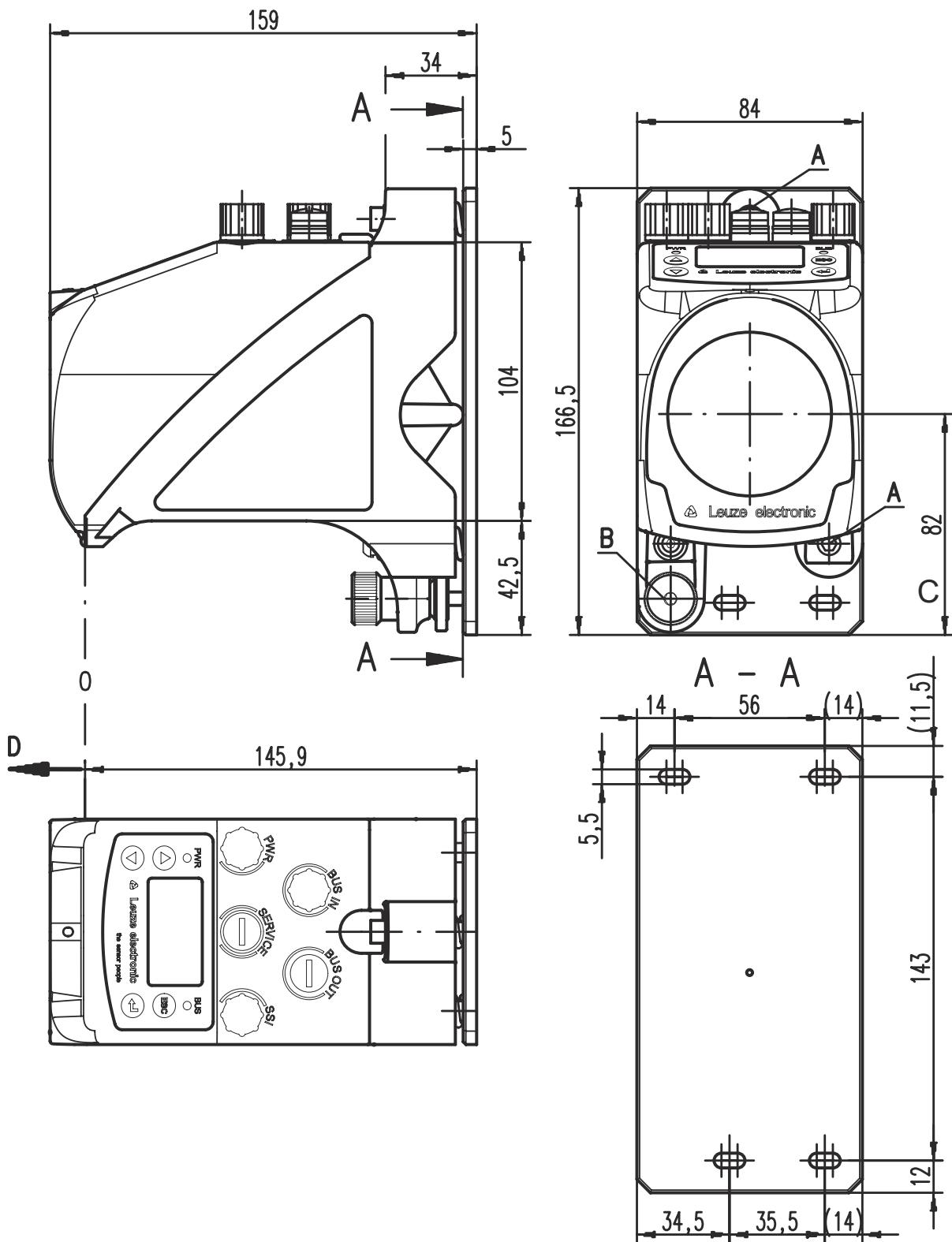
A M 5 Schraube zur Ausrichtung
