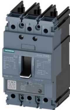
Leistungsschalter 3VA5 UL Frame 125 Schaltvermögenklasse H 65kA @ 480V 3-polig, Anlagenschutz TM230, FTAM, In=35A Überlastschutz Ir=35A fest eingestellt Kurzschlusschutz Ii=5...10 x In ohne Anschluss
