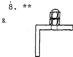
8. Alu Winkel 80 x 80mm mit Senkschraube M10 x 25 und Muttern M10 montieren, danach Alu-Winkel mit Schlitzschraube M6 x 25mm + Federring an das kurze Teil mit angeschweißten Winkel montieren, wobei an jeder Klappe 2 Stk Winkel zu montieren sind. Schrauben noch nicht fest anziehen. In die restlichen Mutterstücke Netzhaken eindrehen, gleichmäßig verteilen und festziehen.
