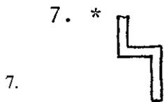
7. Z-Winkel \* zur Aufnahme der Klappensicherung auf Höhe ab Boden von ca. 2,00m an das lange Profil der Klappen mit Schrauben M8 x 25mm und Federscheiben montieren, dabei auf linke und rechte Ausführung achten !!
