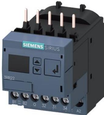
Überwachungsrelais, anbaubar an Schütz 3RT2, Baugröße S00 Standard, digital einstellbar Schein-/Wirkstromüberwachung 1,6-16 A, 20-400 Hz, 3-phasig Versorgung 24-240 V AC/DC 1 Wechsler, 1 Halbleiterausgang für Alarm und Warnung Überwachung auf Stromüber- und Unterschreitung Phasenausfall, Drahtbruch Phasenfolge Fehlerstrom Blockierstrom Warnung und Alarmschwellen mit oder ohne Fehlerspeicher Anlaufverzögerung 0-99 s Störspitzenausblendung 0-30 s Pause nach Fehler 0-300 min Schraubanschlusstechnik
