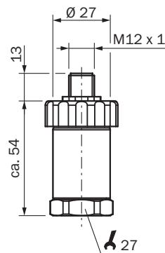
Prozessanschluss mit frontbündiger Membran, G 1 B mit/ohne Kühlstrecke, 0 ... 0,1 bis 0 ... 1,6 bar
