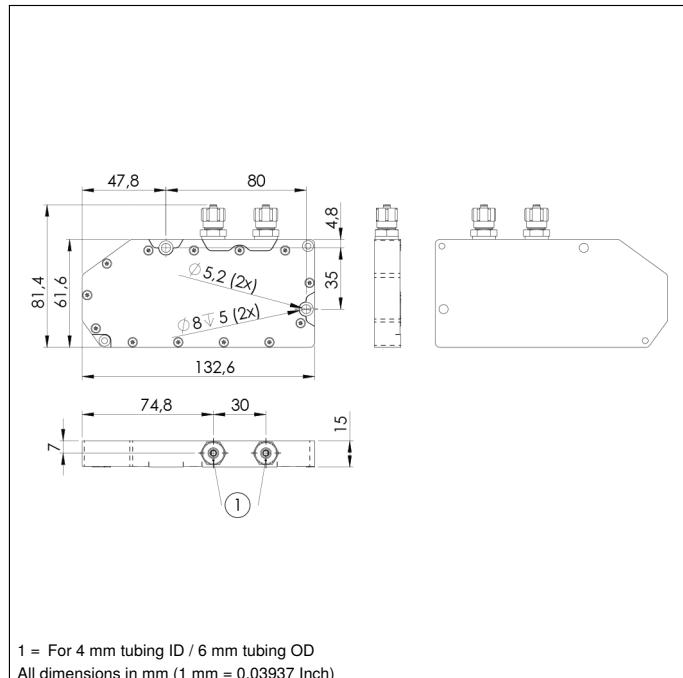
1 = For 4 mm tubing ID / 6 mm tubing OD
