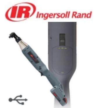
Die QXN-Serie von Ingersoll Rand bietet einen günstigen Einstieg in die Welt der gesteuerten und überwachten Schraubssysteme. Sie hat einen Parameter, der mit bis zu 8 Stufen programmiert werden kann. Drehmoment- und Drehwinkelsteuerung sind kombinierbar. Die Daten werden im Werkzeug gespeichert, die Kommunikation erfolgt über USB-Kabel mit dem PC. Als preisgünstiges Einstiegsmodell besitzt der QXN-Schrauber kein Display.
