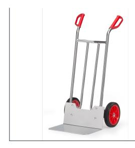
Ensemble mécano-soudé en aluminium. Soigneusement soudé sans revêtement, léger et maniable. Poignées de sécurité en plastique dur. Tablier cintré permettant d'embarquer des éléments ronds tels que rouleaux, bidons, seaux etc. Bavette en tôle d'alu à boulonner et remplaçable. Roues à bandage caoutchouc, moyeu à roulement à rouleaux. Livrée avec bavette démontée.
