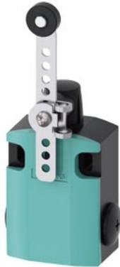
Positionsschalter Metallgehäuse 56 mm breit Geräteanschluss 3x (M20x 1,5) 1S/2Ö Sprungkontakte Schwenkantrieb rechts/links einstellbar, mit längenverstellbarem Metallhebel 100 mm lang und mit Formschluss (Rasterbohrung) und Kunststoffrolle 19 mm
