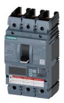
Leistungsschalter 3VA6 UL Frame 150 Schaltvermögenklasse H 65kA @ 480V 3-polig, Anlagenschutz ETU820, LI, In=40A Überlastschutz Ir=16A...40A Kurzschlussschutz Ii=1,5...12 x In ohne Anschluss
