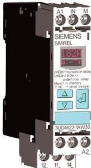
Digitales Überwachungsrelais Stromüberwachung, 22.5 mm von 0,05-10 A AC/DC Über- und Unterschreitung Versorgungsspannung: AC/DC 24 V DC und AC 50 bis 60 Hz ohne galvanische Trennung zum Messkreis Anlauf- und Störspitzenverzög. 0,1 bis 20 s Hysterese 0,01 bis 5 A 1 Wechsler mit oder ohne Fehlerspeicher Schraubanschluss Nachfolgeprodukt für 3UG3522-1AC..
