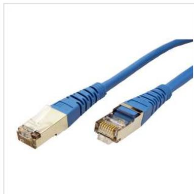
Cordon confectionné doublement blindé avec des connecteurs blindés RJ45 de qualité. Résistant grâce aux connecteurs surmoulés, assignation des connecteurs 1:1 selon la norme EIA / TIA 568A. Structure: tresse de 8 fils, blindage total par feuille d'aluminium et cuivre étamé. Contacts dorés.
