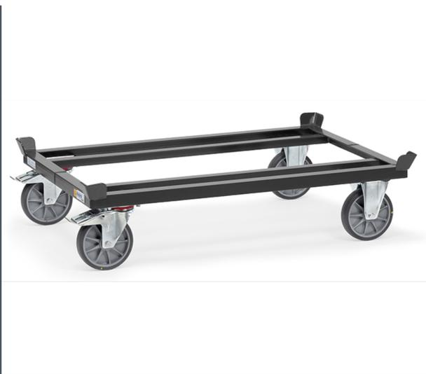
Pour palettes en bois et grillagées, construction renforcée en profilé soudé, avec 4 coins de centrage, revêtement époxy gris RAL 7015, 2 roues pivotantes et 2 fixes, Bandage TPE-ESD, moyeu à roulement à billes, freins sur roues pivotantes. Conformément à la norme 1757-3. Peu de résistance au démarrage et à la rotation, déplacement silencieux sur sols plats. Roues non tracantes.
