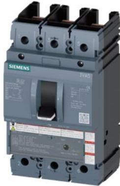
Leistungsschalter 3VA5 UL Frame 250 Schaltvermögenklasse C 100kA @ 480V 3-polig, Anlagenschutz TM240, ATAM, In=150A Überlastschutz Ir=120A...150A Kurzschlusschutz Ii=5...10 x In ohne Anschluss
