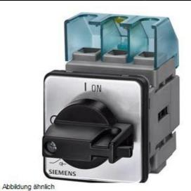
HAUPT-/NOT-AUS-SCHALTER 3-POLIG IU=16, P/AC-23A BEI 400V=7,5KW FRONTBEFESTIGUNG ZENTRALLOCHBEFESTIGUNG KNEBELANTRIEB SCHWARZ
