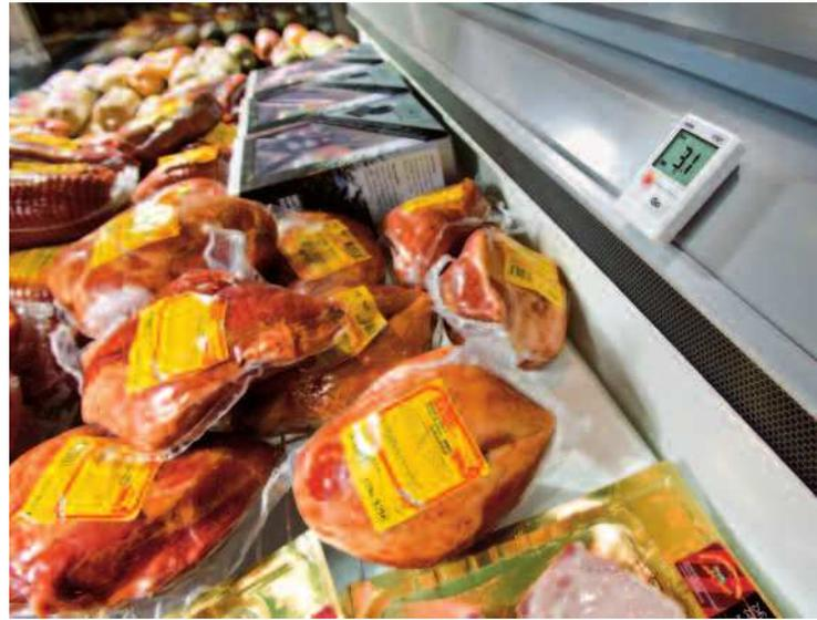
Der Mini-Datenlogger testo 174T ist optimal geeignet für die Temperaturmessung in Kühlschränken, Gefrierschränken, Kühlräumen und Kühlregalen.
