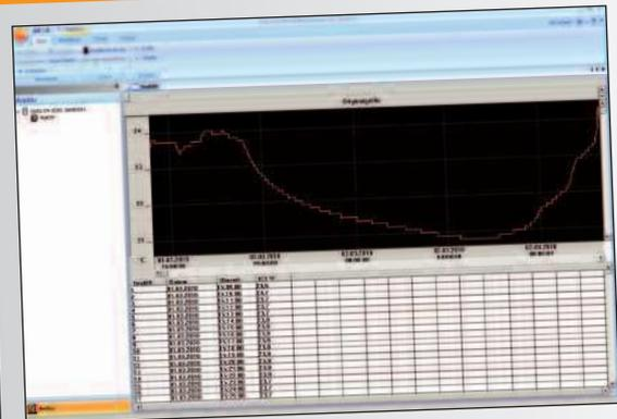
Mit der Software ComSoft testo 174 kann der Datenlogger einfach per USB-Interface konfiguriert und ausgelesen werden. Messdaten können schnell und intuitiv analysiert werden.
