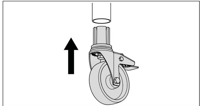
2. Um die Rolle zu befestigen, Schraube der Sprezhülse mit 15 Nm anziehen.
