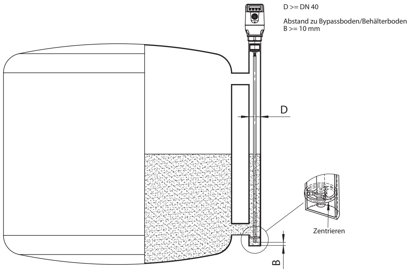
Einbau in einen metallischen Behälter
