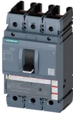
Leistungsschalter 3VA5 UL Frame 250 Schaltvermögenklasse M 35kA @ 480V 3-polig, Anlagenschutz TM210, FTFM, In=70A Überlastschutz Ir=70A fest eingestellt Kurzschlusschutz li=10 x In UL 489 SB (Naval), 50° C ohne Anschluss
