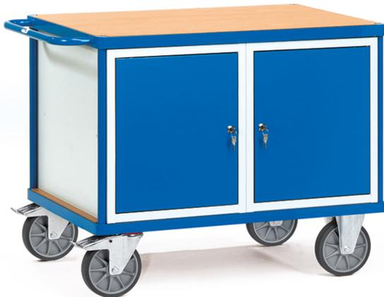
Baukasten-System: Stahlrohr und Profilstahl geschweißt, pulverbeschichtet. Böden aus Holzwerkstoffplatte, Oberfläche Buchendekor, bündig im Stahlrahmen liegend. 2 verschließbare Schränke mit Flügeltür, je 1 fester und 2 verstellbare Böden im Schrank. Abmessungen
