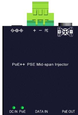
Power over Ethernet bietet eine Möglichkeit für Ethernet-Netzwerkgeräte, über UTP-Kabel, einschließlich Cat.5, 5e und 6, statt über separate Netzkabel mit Strom versorgt zu werden. Bei dem Gerät handelt es sich um einen Mid-Span-Injektor, der Ausgangsleistung liefern kann und proprietäre PoE++ 90-W-PDs vom Typ 4, 802.3at-PDs vom Typ 2 mit hoher Leistung und 802.3af-PDs vom Typ 1 unterstützt. Der Injektor unterstützt sowohl Fast-Ethernet-Verbindungen als auch Gigabit-Ethernet-Verbindungen.
