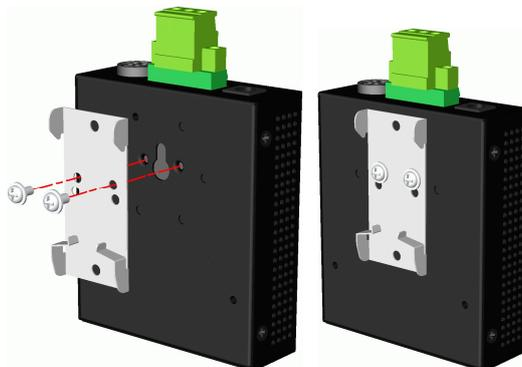
2. Befestigen Sie die Halterung an der Unterkante der DIN-Schiene und schieben Sie das Gerät ein wenig nach oben, bis die Halterung an der Oberkante der DIN-Schiene festklemmen kann.
