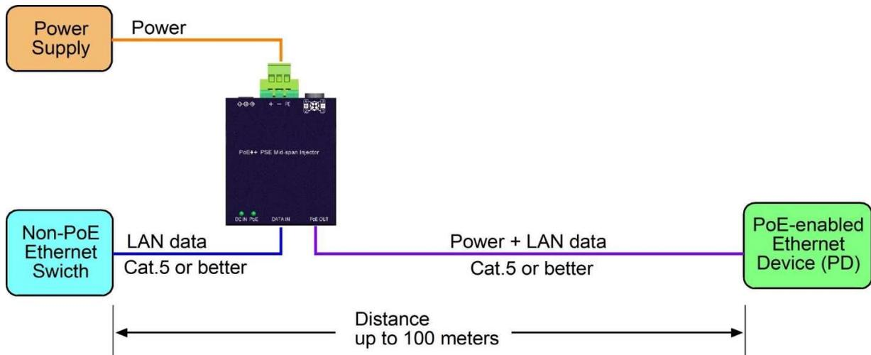
Die Kabelentfernung, einschließlich des Segments vom Injektor zum Ethernet-Gerät und des Segments zum PD, beträgt nicht mehr als 100 Meter.
