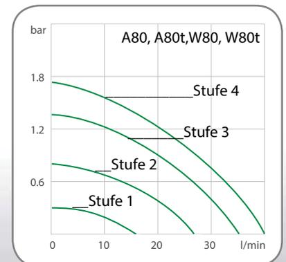
Alle Daten beziehen sich auf die Netzspannung 230 V, Nennfrequenz 50 Hz (bzw. 400 V, 3Ph., 50 Hz) und Umgebungstemperatur +20 °C. Messungen der Kälteleistungen bei max. Pumpenstufe. Alle Pumpendaten bezogen auf Medien mit spezifischer Dichte von 1 kg/dm<sup>3</sup>. Kälteleistungswerte gemessen mit Thermal HL (+200 °C) oder Ethanol (außer +200 °C).
