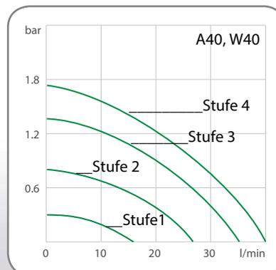
Alle Daten beziehen sich auf die Netzspannung 230 V, Nennfrequenz 50 Hz und Umgebungstemperatur +20 °C. Messungen der Kälteleistungen bei max. Pumpenstufe. Alle Pumpendaten bezogen auf Medien mit spezifischer Dichte von 1 kg/dm<sup>3</sup>. Kälteleistungswerte gemessen mit Thermal HL (+200 °C) oder Ethanol (außer +200 °C).
