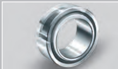
Radialgelenklager mit ELGOGLIDE® (Ø 17–300 mm): ideales Verhältnis Lagergewicht/Belastbarkeit
