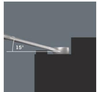
Die Ringseite ist um 15° zur Werkzeugachse abgewinkelt, um Verletzungen vorzubeugen.
